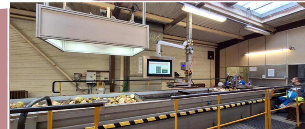
Sur le site de Corbeilles-en-Gâtinais, les réalisations auront porté sur les châssis ouverts pour le MCC, le système ABB 800XA/S800, l'automate de pesage (Wago) et le coffret E/S déporté.
